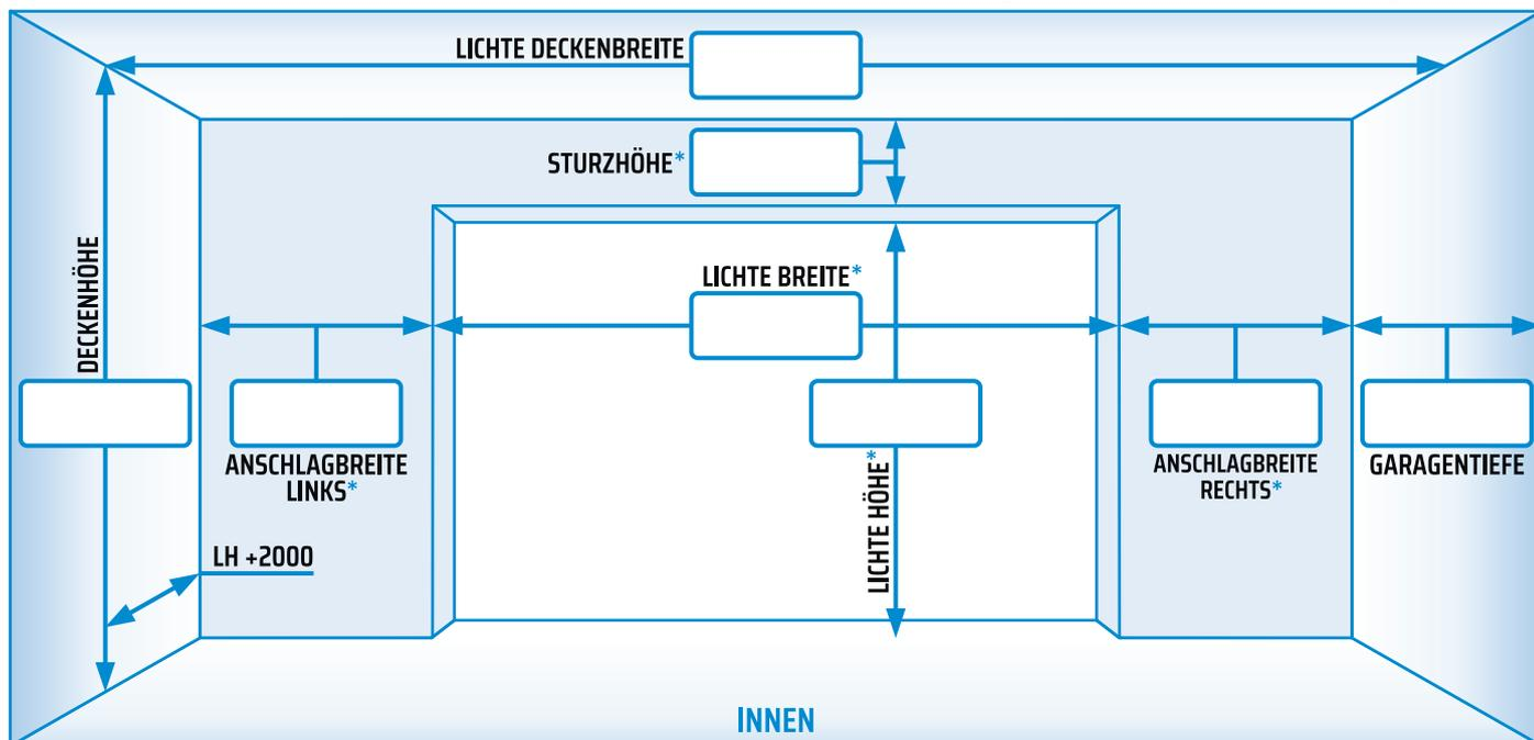
Maße sind Fertigmaße (Oberkante fertiger Fußboden). Alle Maße in Millimeter eintragen!
