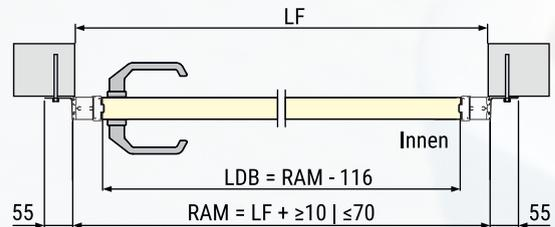
Montageart: Einbau hinter der Öffnung
