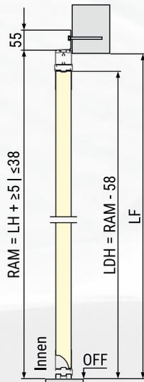
Montageart: Einbau hinter der Öffnung
